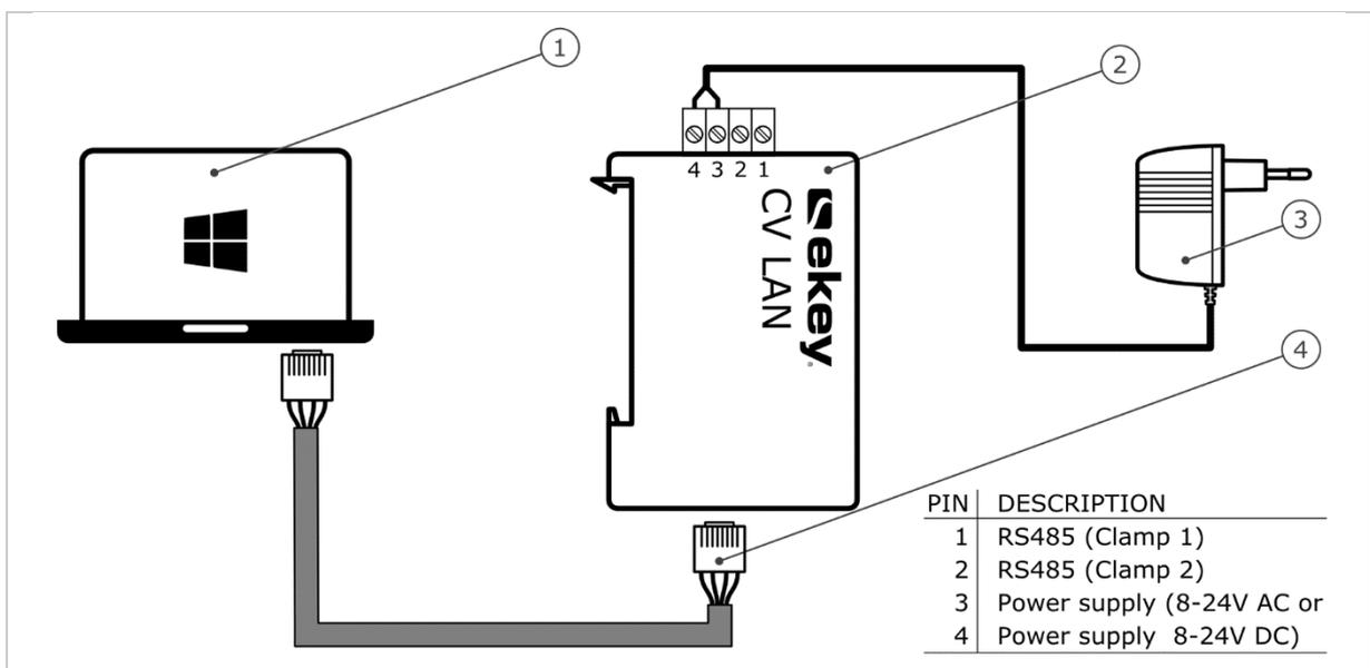
Abb. 5: Verkabelungsplan für die Konfiguration des Konverters
