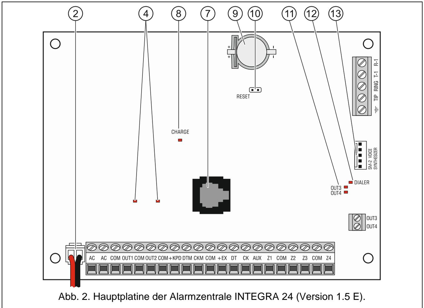
Abb. 2. Hauptplatine der Alarmzentrale INTEGRA 24 (Version 1.5 E).
