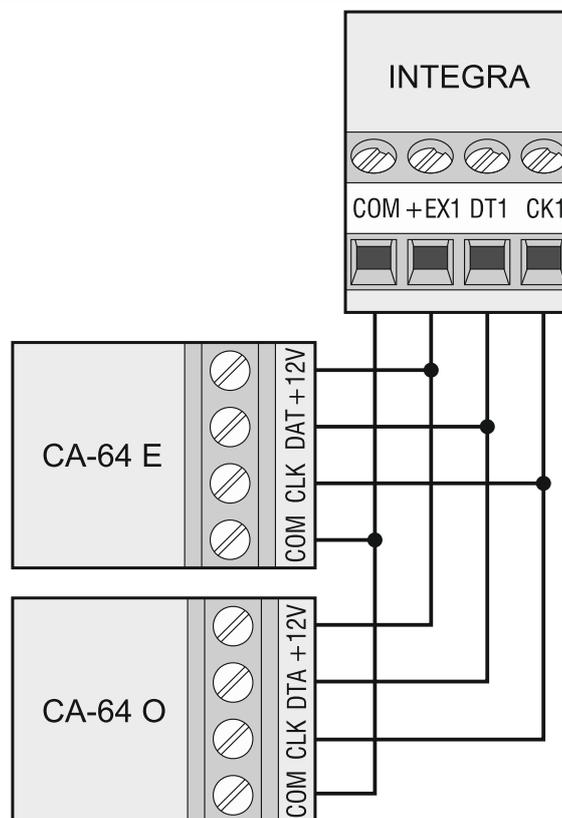
Abb. 8. Anschluss der Module ohne Netzteil.
