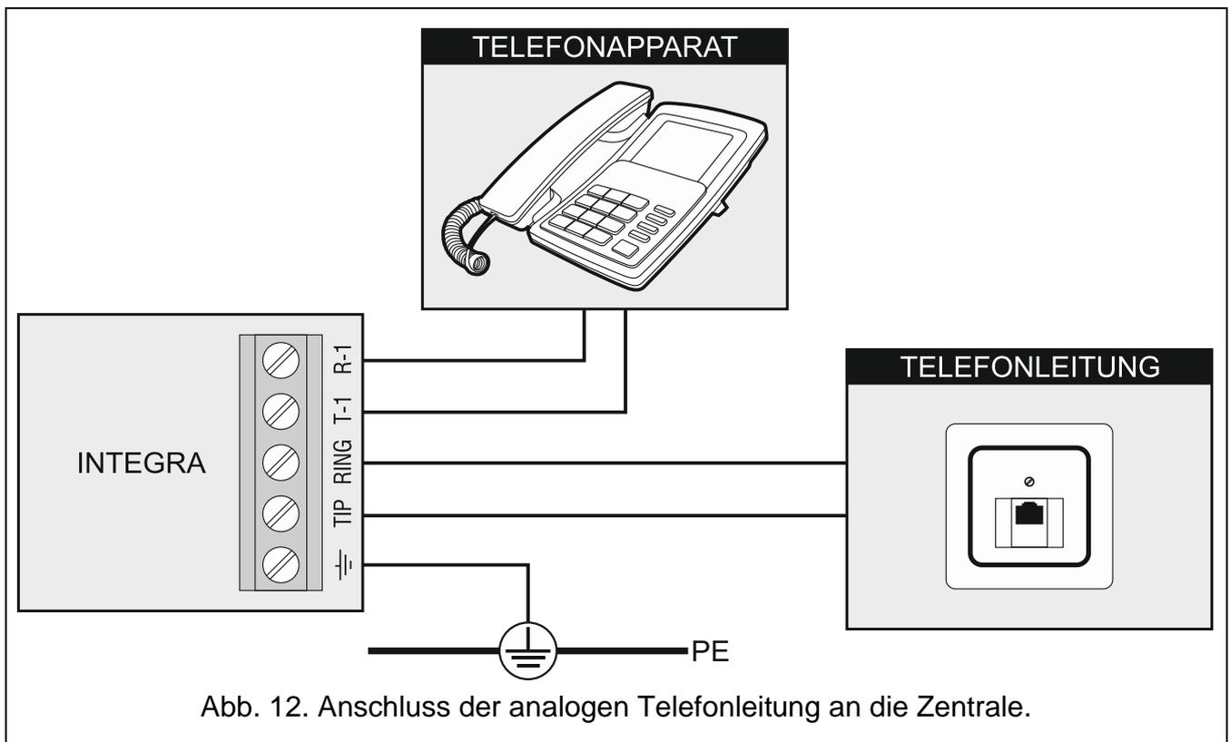
Abb. 12. Anschluss der analogen Telefonleitung an die Zentrale.
