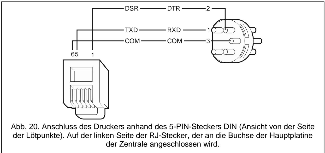
Abb. 20. Anschluss des Druckers anhand des 5-PIN-Steckers DIN (Ansicht von der Seite der Lötunkte). Auf der linken Seite der RJ-Stecker, der an die Buchse der Hauptplatine der Zentrale angeschlossen wird.
