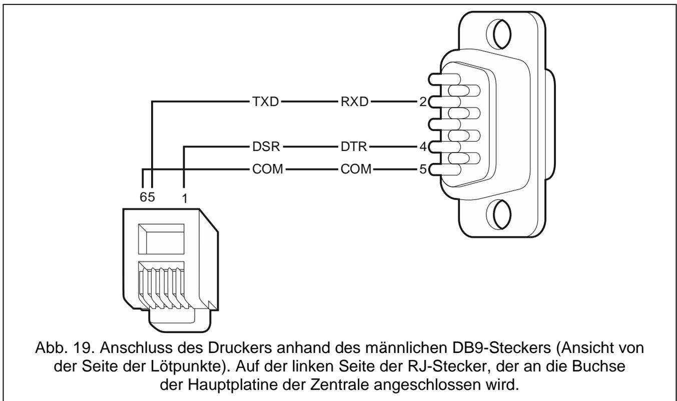
Der Port RS-232 der Zentrale ermöglicht den Anschluss eines Druckers, der mit einer seriellen Schnittstelle ausgestattet ist. Die Ereignisse können in einer Kurzform (ein Ereignis
