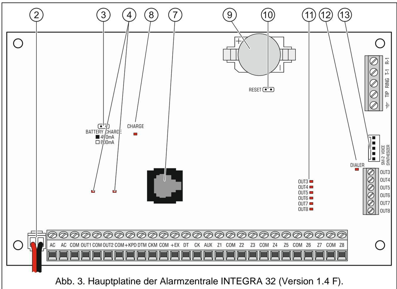
Abb. 3. Hauptplatine der Alarmzentrale INTEGRA 32 (Version 1.4 F).
