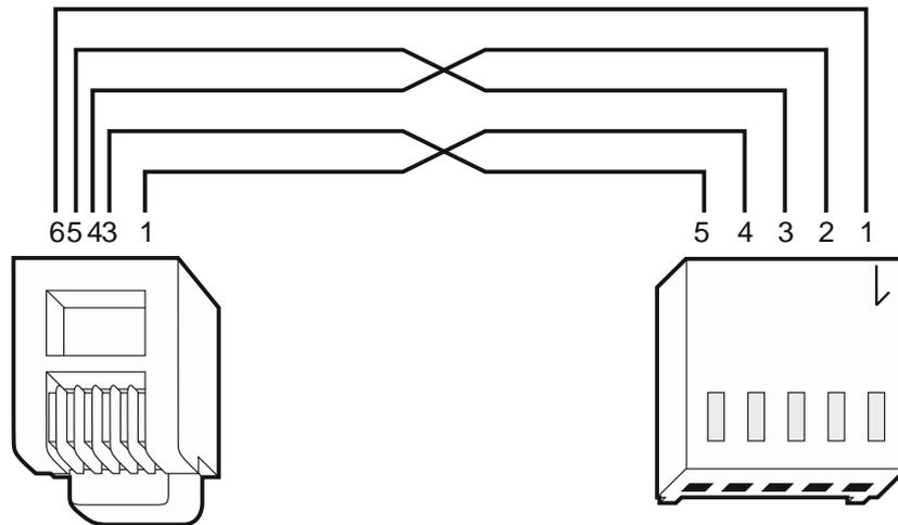
Abb. 17. Anschluss der RS-232-Schnittstellen der Zentrale und eines externen Modems mit der Buchse PIN5 (auf dieselbe Weise werden die von SATEL hergestellten Module ETHM-1 / ETHM-1 Plus und GSM angeschlossen). Auf der linken Seite der RJ-Stecker, der an die Buchse auf der Hauptplatine der Zentrale angeschlossen wird. Auf der rechten Seite der PIN5-Stecker. Das Kabel RJ/PIN5 ist im Angebot der Firma SATEL verfügbar.
