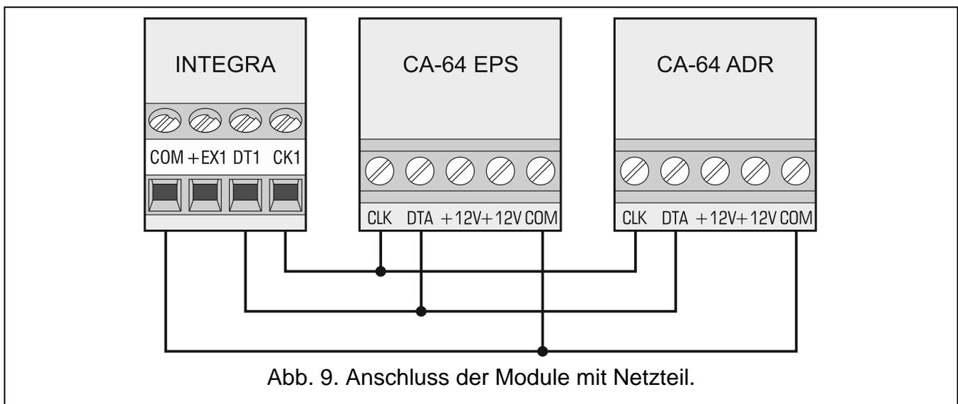
Abb. 9. Anschluss der Module mit Netzteil.
