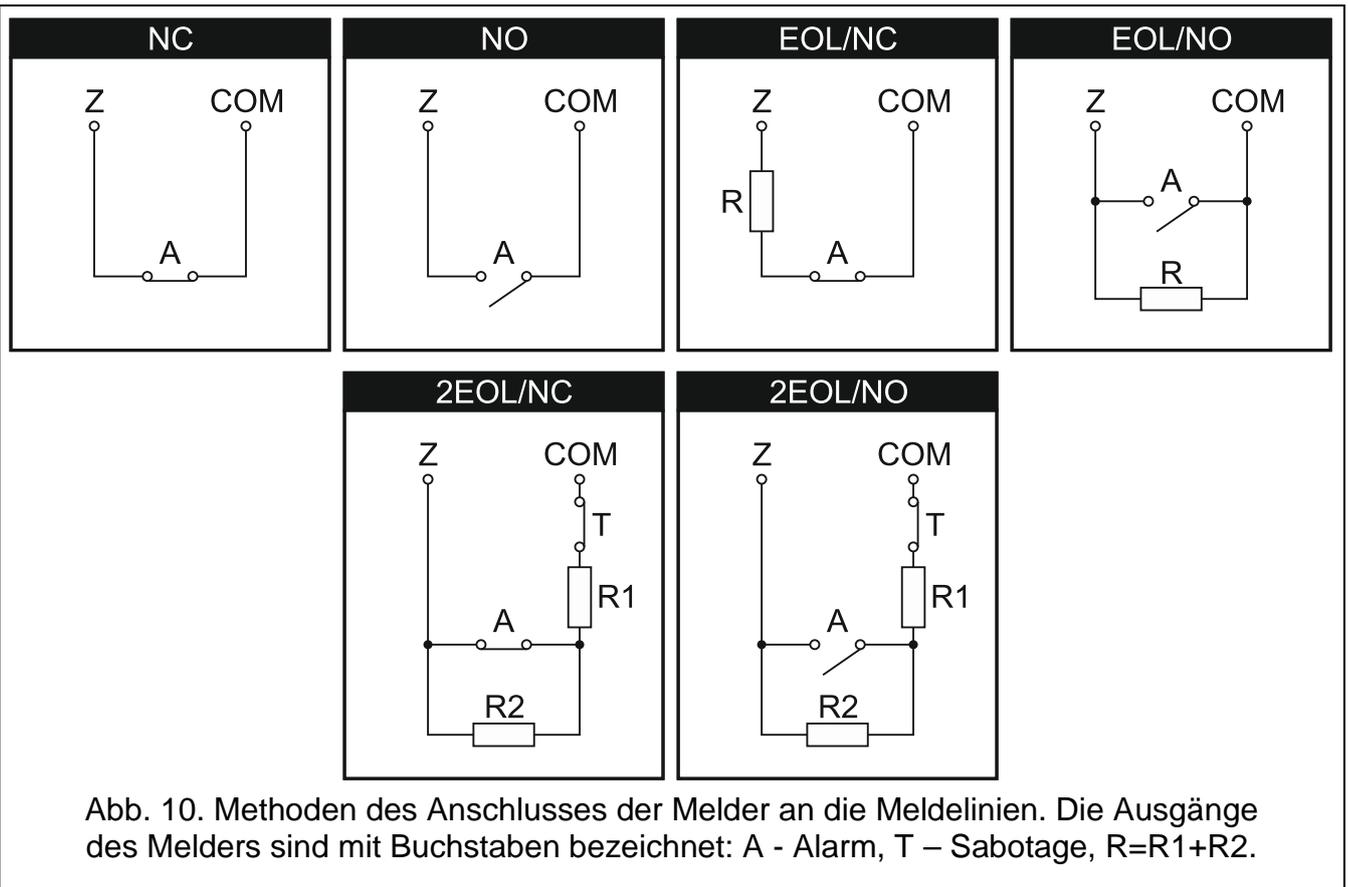
Abb. 10. Methoden des Anschlusses der Melder an die Meldelinien. Die Ausgänge des Melders sind mit Buchstaben bezeichnet: A - Alarm, T – Sabotage, R=R1+R2.
