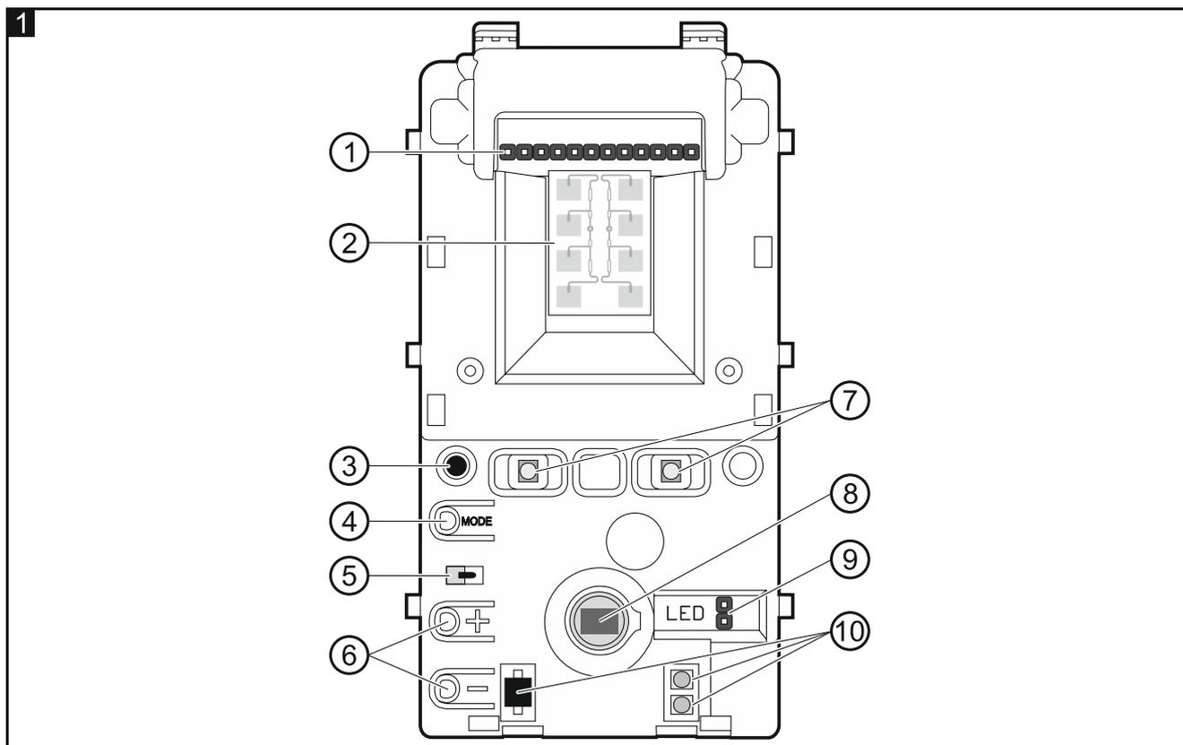
① Pins zur Konfiguration der Ausgänge des Melders. Die verfügbaren Einstellungen sind in folgenden Abbildungen veranschaulicht:
