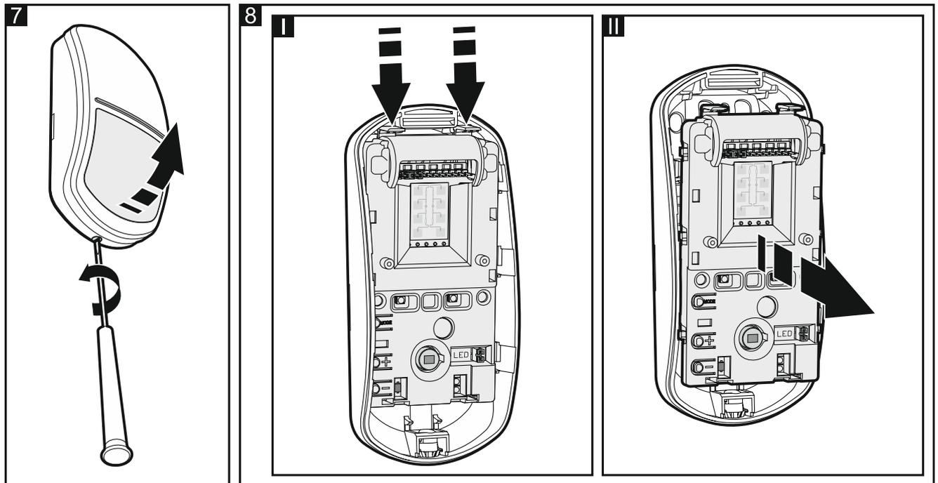
1. Öffnen Sie das Gehäuse (Abb. 7).
