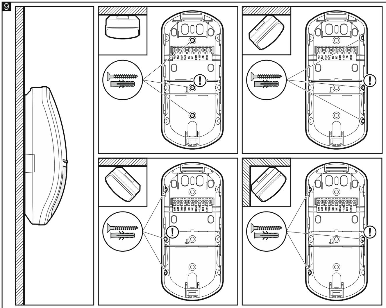
5. Befestigen Sie das Gehäuseunterteil an der Wand (Abb. 9) oder an der Halterung, die an die Wand oder Decke angeschraubt ist (Abb. 10). Die mitgelieferten Dübel sind für Untergründe wie Beton, Ziegel etc. bestimmt. Im Falle eines anderen Untergrundes (Gips, Styropor) verwenden Sie andere, entsprechend angepasste Dübel.
