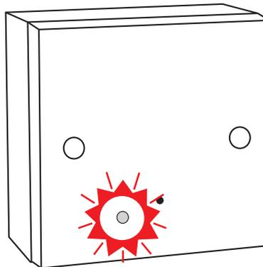
Die LED blinkt für einen Moment schnell auf, wenn das Gerät in den Hauscodierungsmodus schaltet.
