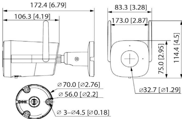
Abbildung 3-1 Abmessungen (Einheit: mm [Zoll])
