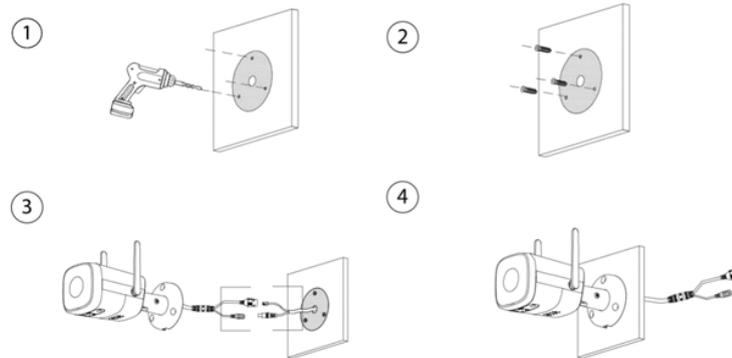
Abbildung 3.3 A - Kabeldurchführung durch die Montagefläche
