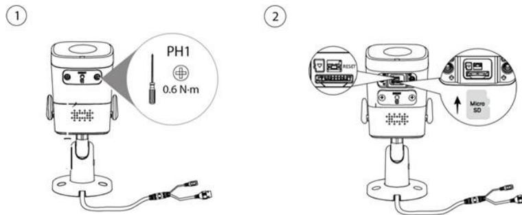
Abbildung 3-2 Einsetzen einer SD-Karte (Einheit: mm[Zoll])
