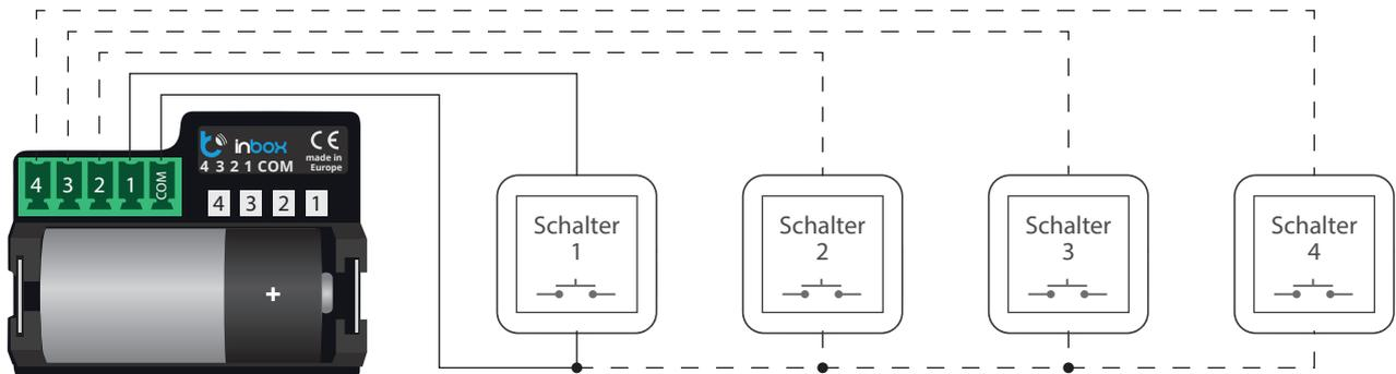
schließen Sie von einem bis zu vier monostabilen Schaltern an
