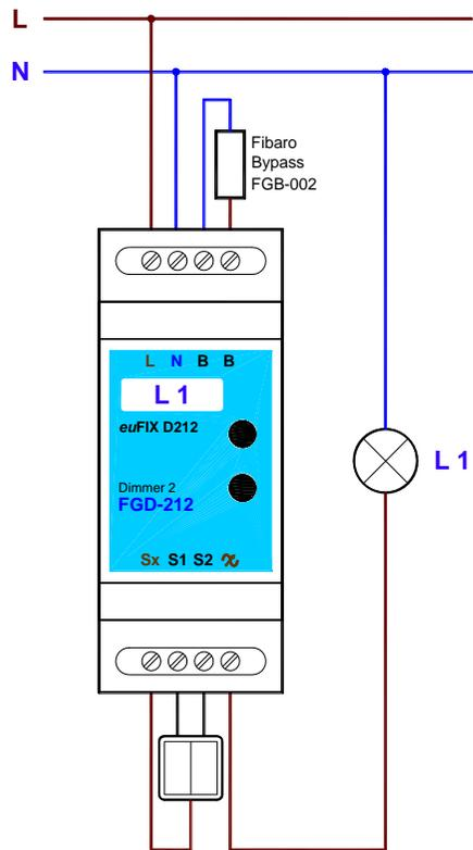
Die Beschreibungen der Schraubklemmen werden auf dem Etikett des Adapters angegeben. Das Symbol der Sinuskurve mit Pfeil bedeutet den Ausgang des Verdunklers, die Buchstaben „B“ kennzeichnen die Anschlussstellen des optionalen Moduls Fibaro Bypass FGB-002.
