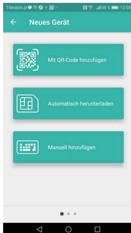
Abb. 36. GX Control App (Betriebssystem Android): Wahl der Konfigurationsmethode der Einstellungen für neues Modul.
