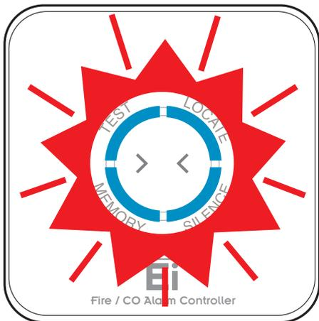
Alle Leuchtsegmente blinken 1 x schnell auf, wenn das Gerät in den Hauscodierungsmodus schaltet.
