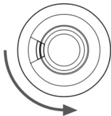
Drehen Sie das Gerät gegen den Uhrzeigersinn. Das Gerät löst sich nicht: möglicherweise ist es eingriffsicher montiert (siehe Abbildung 12c).
