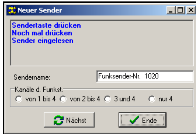
Abb. 4. Fenster für die Hinzufügung neuer Handsender im Programm DLOAD10.
